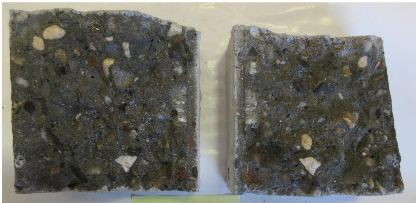
Figura 2 Sezione di rottura spruzzata con acqua per la misura della profondità di penetrazione
