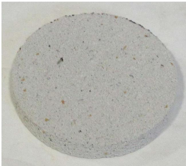
Figura 1. Riproduzione fotografica del prodotto "ELIOSIL W 119" posato in laboratorio su opportuno substrato.
